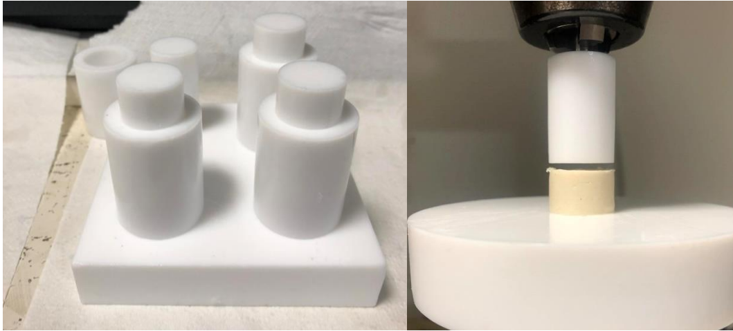
Figure 18 : Photos des moules cylindriques en Téflon (à gauche) et d'un pâton déformé entre le plateau et le piston en Téflon (à droite)
